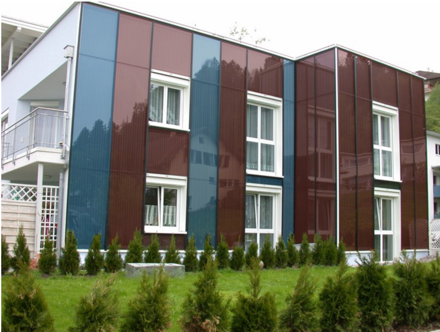
Farbige Absorber mit optisch selektiver Beschichtung
